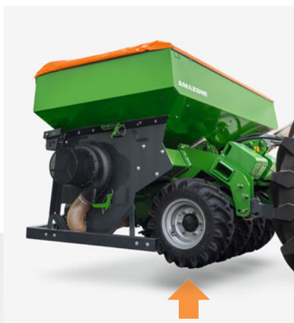
FTender avec rouleau Pneupacker T-Pack F en position de transport
