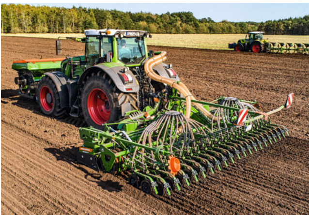
KG 6002-2 repliable avec une largeur de travail de 6 m et unité de semis compacte Avant et éléments semeurs TwinTeC
