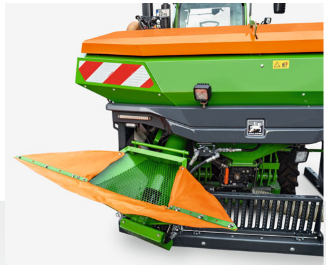
Une vis de remplissage en option est disponible avec cône pliable qui permet un remplissage direct depuis la remorque. En position de transport, la vis de remplissage est parfaitement fermée par un couvercle
