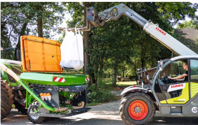
Grande ouverture de trémie de 1,10 m x 2,20 m pour un remplissage rapide et simple de la FTender
